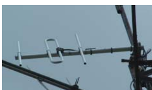
Un esempio di antenna direttiva Yagi a 3 elementi
